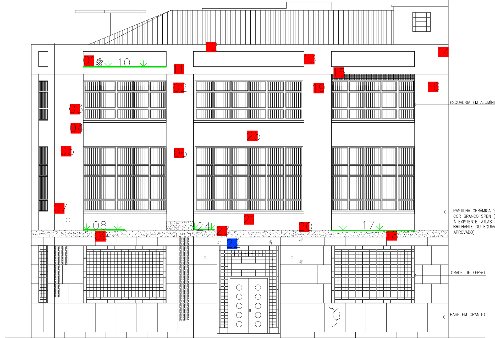
4 PATOLOGIAS FACHADA FRONTAL EXISTENTE/RUA VISCONDE DE INHAÚMA ESCALA: 1/100
