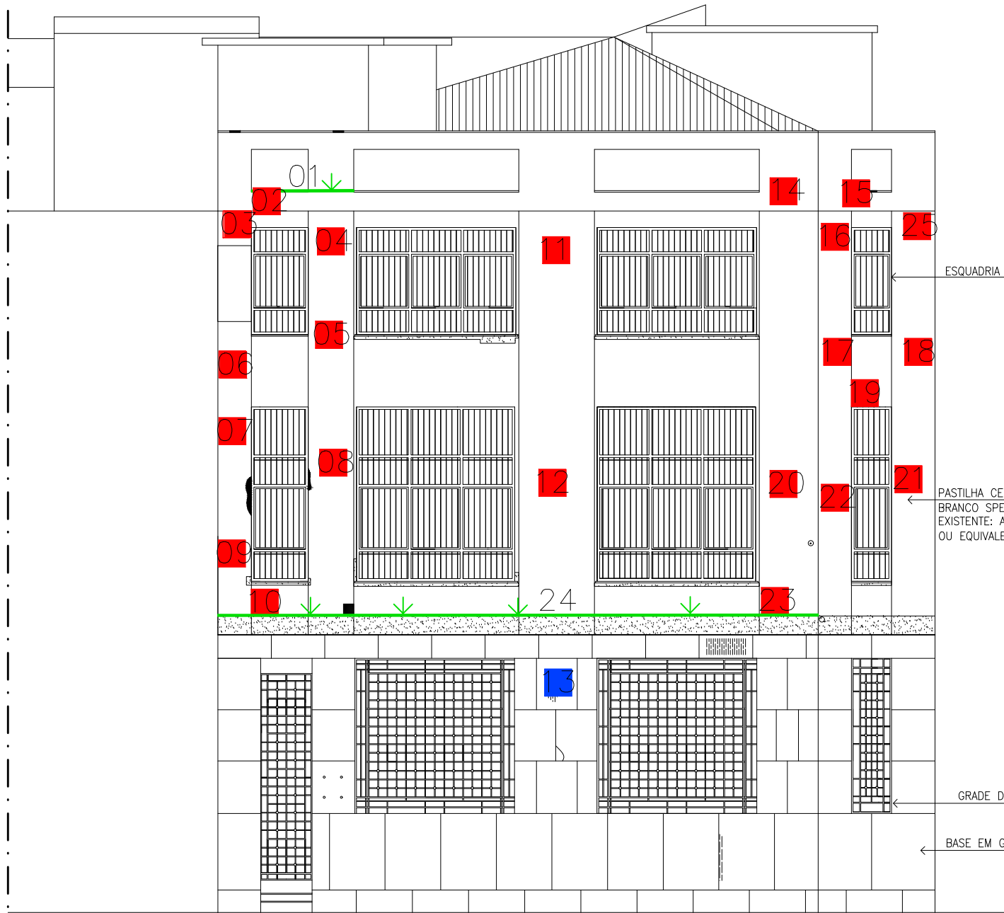
3 PATOLOGIAS FACHADA LATERAL EXISTENTE/RUA DA QUITANDA ESCALA: 1/100
